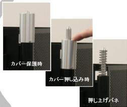
ロボット把持専用の連結ピンを用意し、ロボットによるコンテナの把持が確実かつ容易に行えるようにしている。また、平時は安全のため保護カバーでピンを覆っている。
